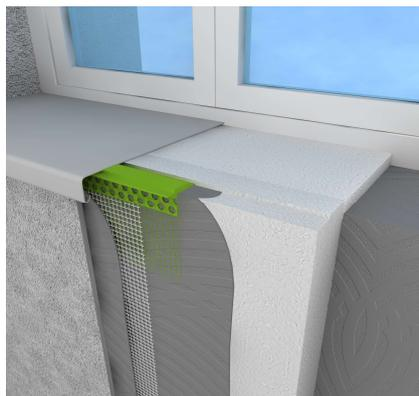
Perfil autoadhesivo para alféizar de PVC con malla de fibra de vidrio álcali-resistente y certificada ETAG 004, se emplea para una ejecución duradera y estanca de los alféizares estándar de aluminio, madera, PVC, piedra o realizados a medida, creando una unión flexible de éste con la estructura ETICS-SATE.
