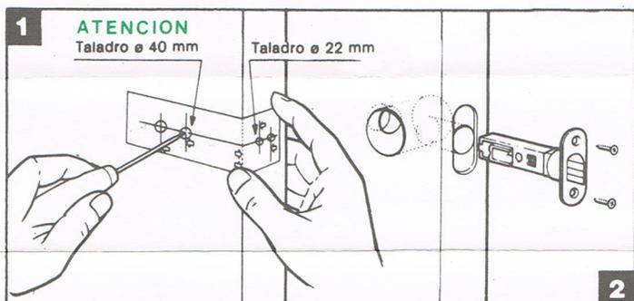
1) Practicar los taladros de  $\varnothing$  40 mm. y  $\varnothing$  22 mm. a 100 cm. del suelo, utilizando la plantilla.
