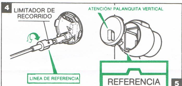
4) (Sólo para los artículos 12 y 13). Antes de montar el frontal del pomo interior, comprobar que el sentido de rotación de la palanquita corresponde a la mano de la puerta. Caso de tener que cambiarlo, deslizar el limitador de recorrido manteniendo la palanquita vertical, y girar la línea de guía de manera que encaje en la posición 1 para el sentido contrario a las agujas del reloj, o en la posición 2 para el sentido de las agujas del reloj.
