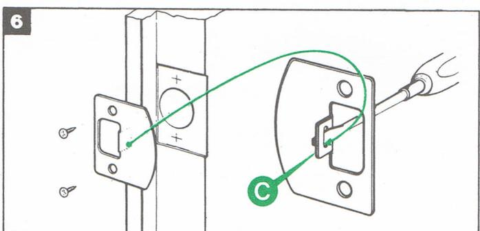
5) Aproximar e introducir el frontal interior manteniendo vertical la palanquita. En esta operación hay que evitar movimientos de rotación. Buscar la correspondencia de las referencias en la parte inferior del pomo y encajar a presión el frontal.
